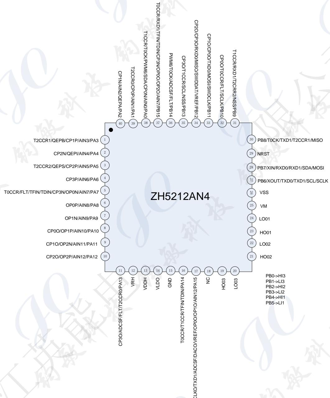
图 3-1-4 ZH5212AN4 (QFN40) 引脚图
